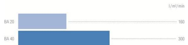
Bedingungen:  $\Delta p = 100 \text{ kPa}$  (1 bar), Medium: Wasser bei 20 °C
